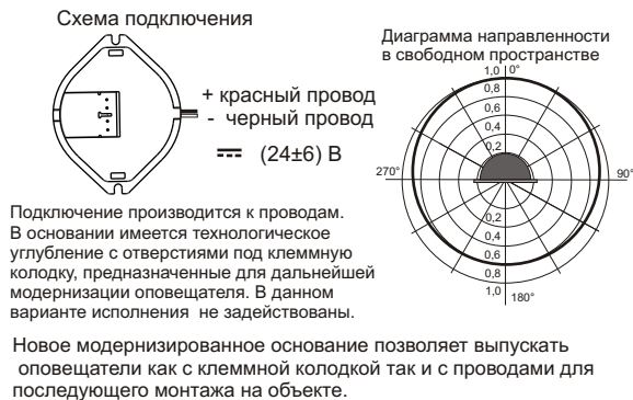
Рис.2 Схема подключения и диаграмма направленности Оповещателя.
