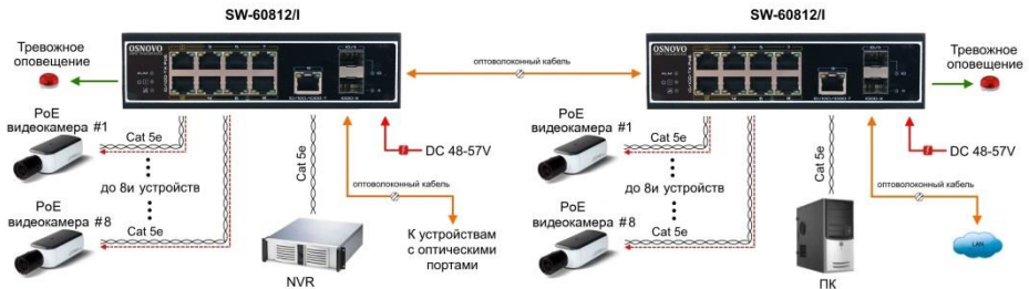
Рис.5 Схема каскадного подключения коммутатора SW-60812/I
