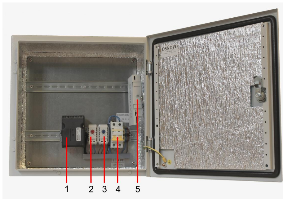
Рис.2 Уличная станция с обогревом и «теплым» пуском, внутренние компоненты на примере модели OS-44H2
