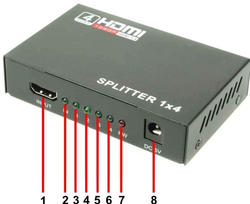
Рис.2 HDMI разветвитель D-Hi1041, разъемы и индикаторы на передней панели
