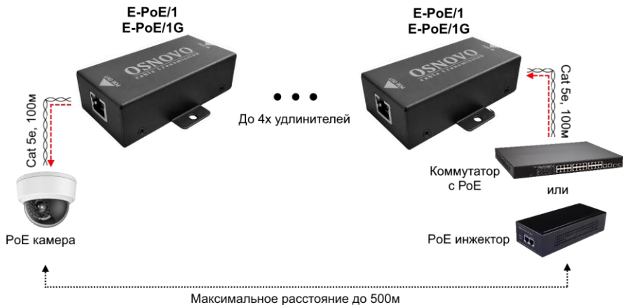
Рис.4 Схема подключения удлинителей E-PoE/1, E-PoE/1G.
