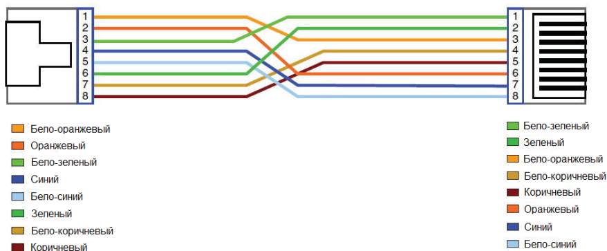
Рис.7 Обжимка кабеля по типу TIA/EIA-568-B.
