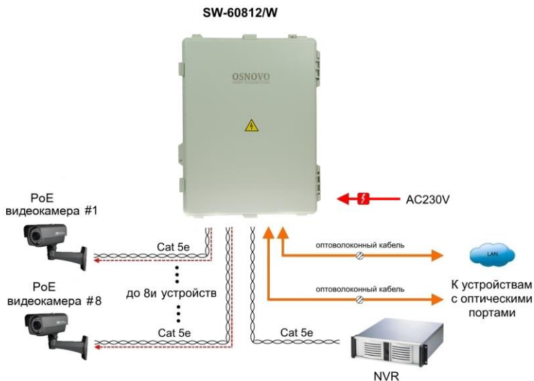
Рис.6 Типовая схема подключения коммутатора SW-60812/W
