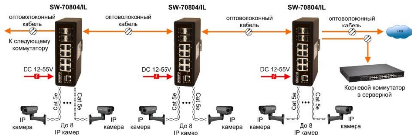
Рис.6 Типовая схема подключения коммутатора на примере SW-70804/IL
