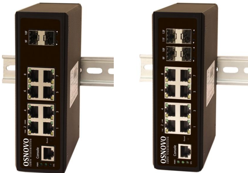
Рис.1 Коммутаторы SW-70802/IL, SW-70804/IL, внешний вид
