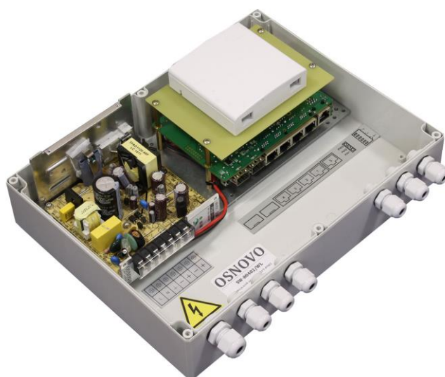
Рис. 2 Уличный коммутатор SW-80402/WL, внешний вид внутри
