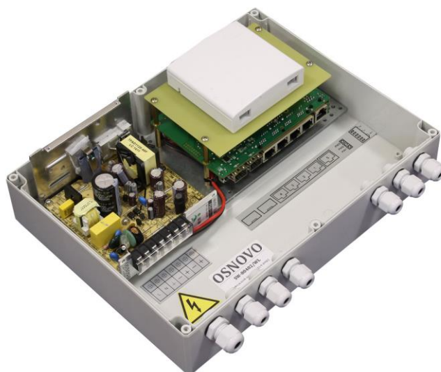
Рис. 2 Уличный коммутатор SW-80402/WL, внешний вид внутри
