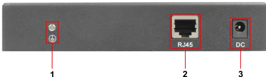
Рис. 5 Приемник RA-VKMDA, разъемы на задней панели
