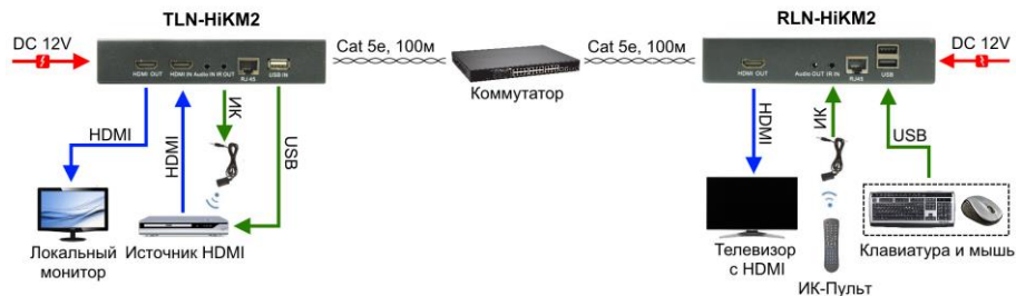
Рис.8 Схема подключения комплекта TLN-HiKM2+RLN-HiKM2 в режиме «точка-точка» через коммутатор
