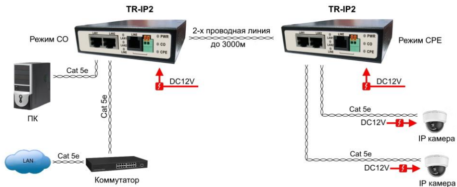
Рис.5 Типовая схема подключения удлинителя TR-IP2
