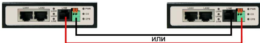
Рис.8 Схема перекрестного соединения CO (сервера) и CPE (клиента).
