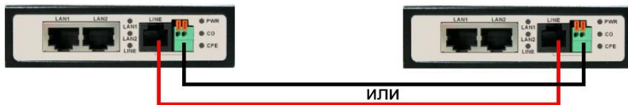
Рис.7 Схема прямого соединения CO (сервера) и CPE (клиента).
