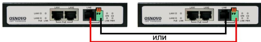
Рис.7 Схема перекрестного соединения CO (сервера) и CPE (клиента).
