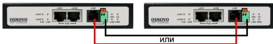
Рис.6 Схема прямого соединения CO (сервера) и CPE (клиента).
