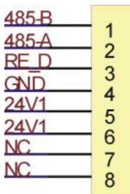
Рис.4 Назначение контактов в разъёме RJ45
