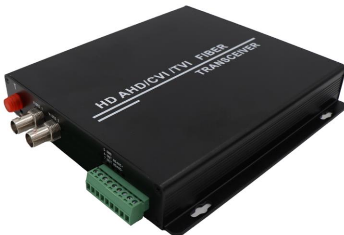
Рис.2 Передатчик TA-H22-15F / приемник RA-H22-15F, внешний вид
