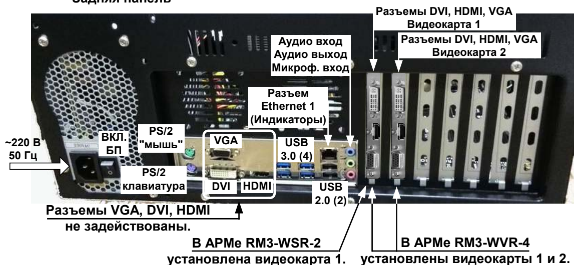
Рис. 9 RM3-WSR-2 (одна видеокарта) и RM3-WVR-4 (две видеокарты) . Конструкция, органы управления, индикаторы, разъемы подключения.
