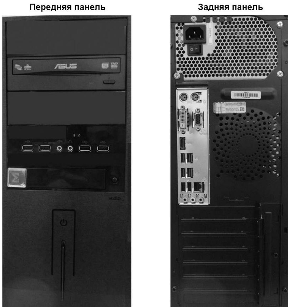
Рис. 3 ИД-ССД, включая исп. 2, исп. 3. Возможный вариант конструкции, органов управления, индикаторов, разъемов подключения сервера.
