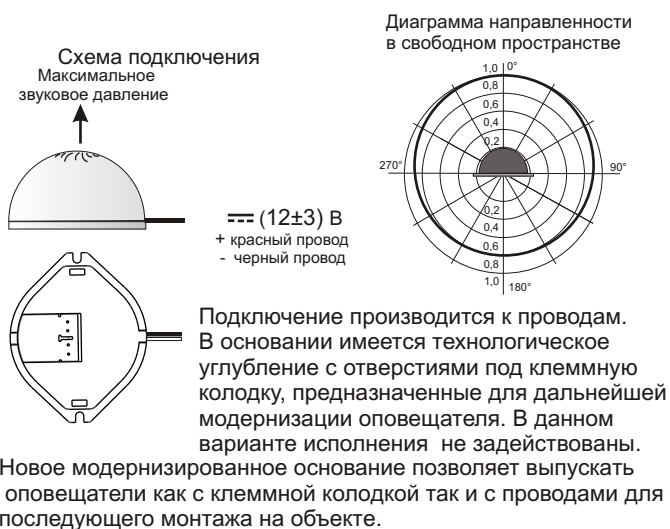
Рис.2 Схема подключения и диаграмма направленности оповещателя.
