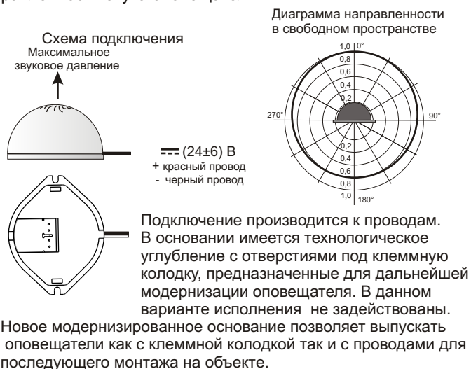
Рис.2 Схема подключения и диаграмма направленности оповещателя.
