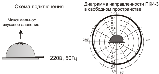
Рис.2 Схема подключения и диаграмма направленности оповещателя ПКИ-3.
