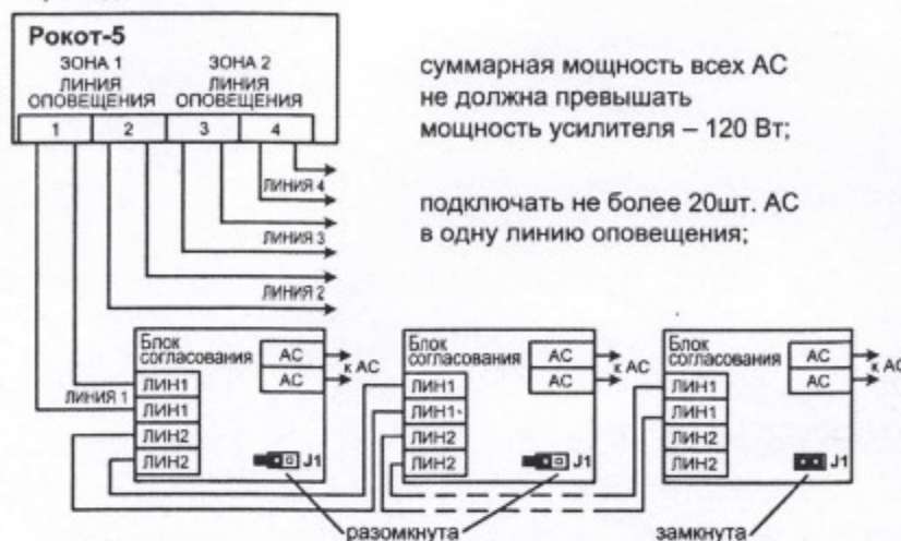
Рис.1 Схема подключения АС через плату согласования к Рокот-5 ПУО и Рокот-5 УМ
