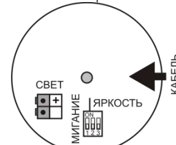
Рис.4 – Расположение клеммников и микропереключателей в коммутационном отсеке оповещателей «Плазма»Ех(м)-С-40х20
