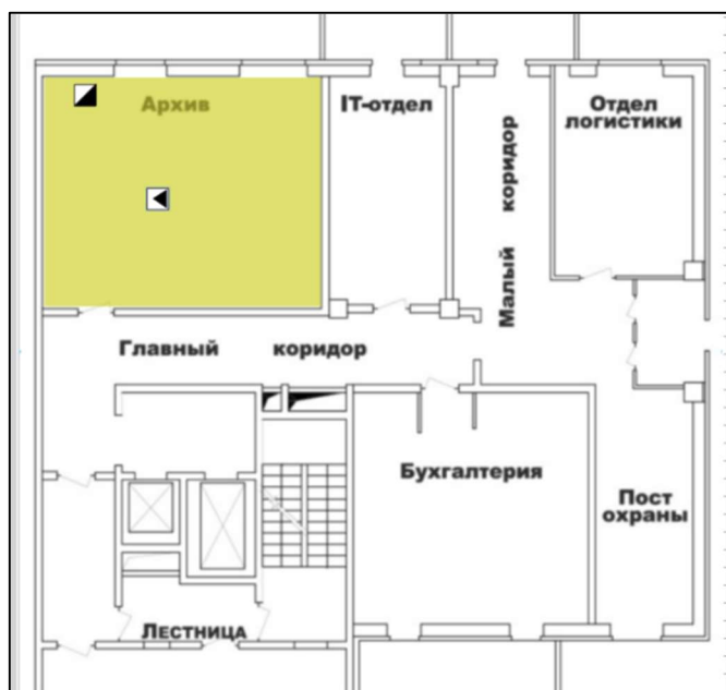
Рисунок Б.25 – Расположение устройств в зоне «Архив»
