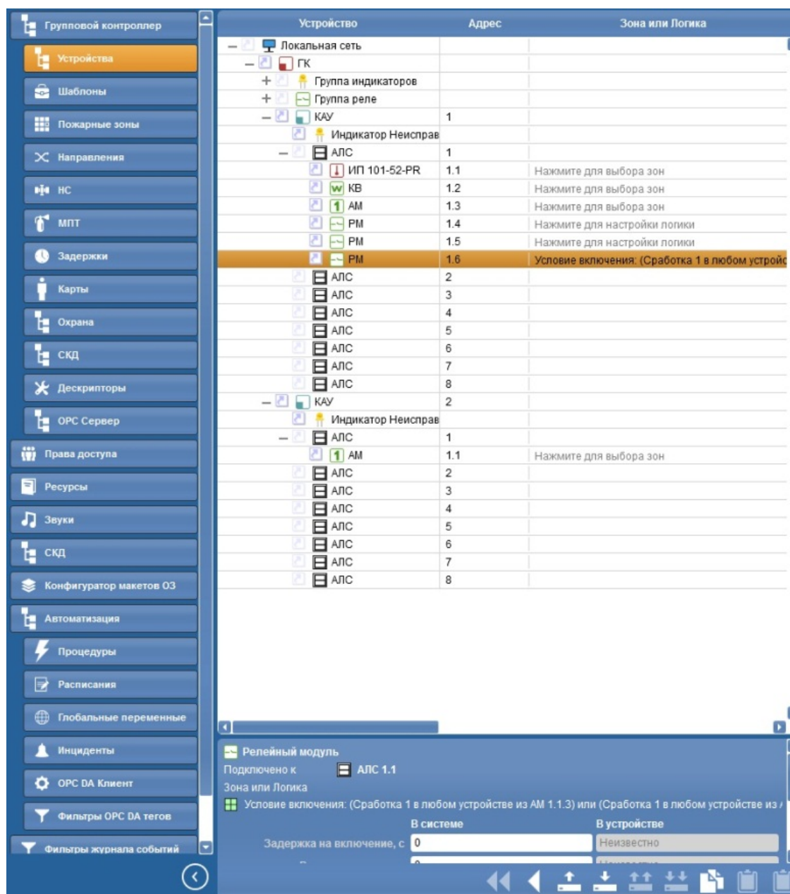
Рисунок 10.9 – Дерево устройств, к ГК подключено два КАУ
