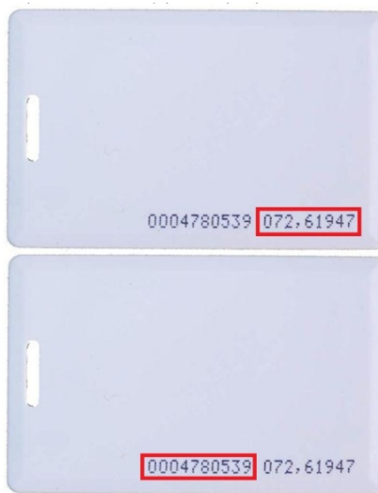
Карта EM Marine с различными вариантами записи её номера.
