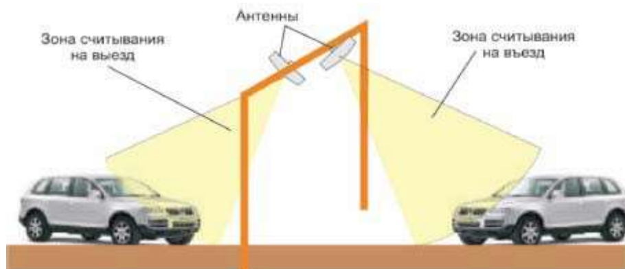
Рис. 1.18 Считыватель «Parsec» PR-G07 с антеннами для проезда на въезд и выезд
