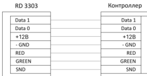
Рисунок 2.27 Схема подключения считывателя «КОДОС RD-3303» к контроллерам КОДОС ЕС-211, 212, 222, 213
