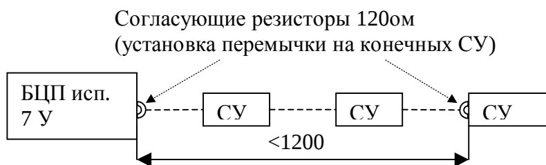
Рис. 4 Подключение БЦП исп. 7У к СУ по линии RS-485.
