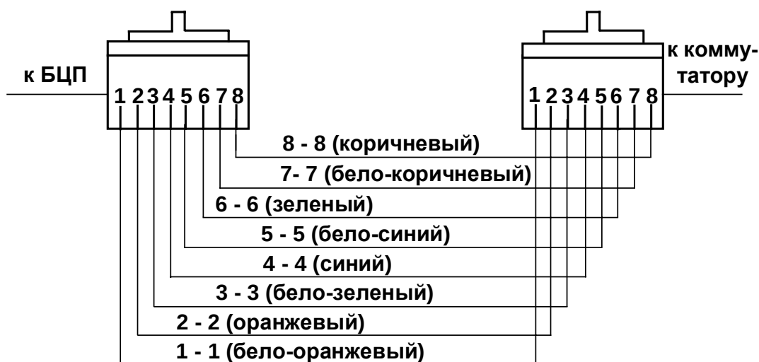
б) Прямой кабель (соединение БЦП и коммутатора)
