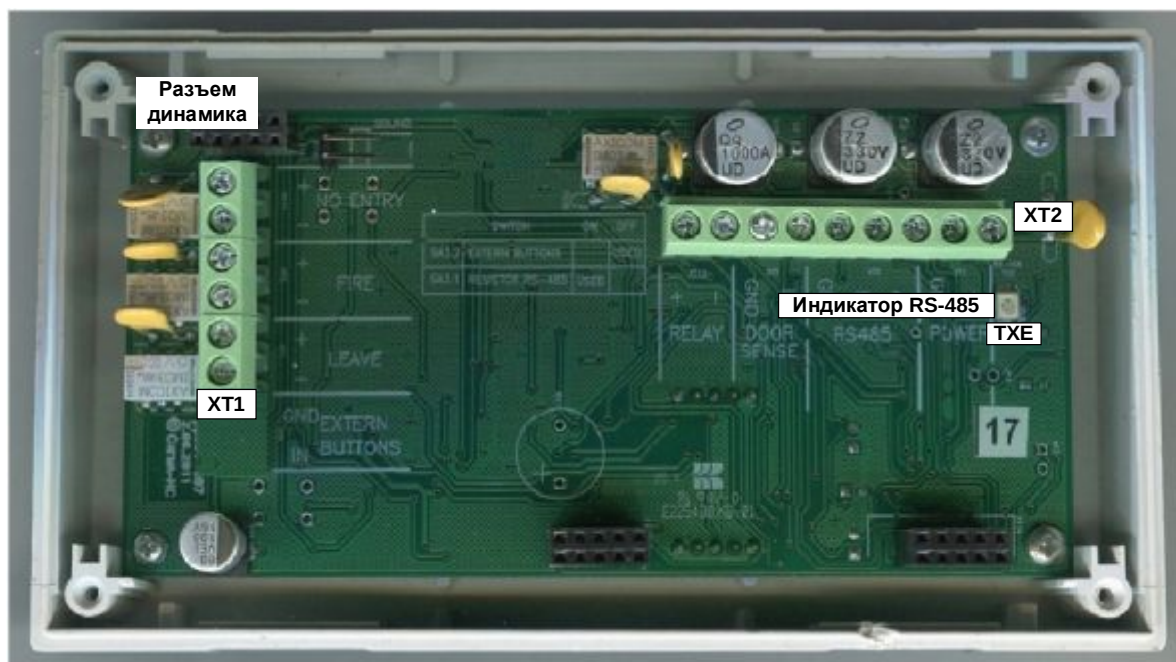
Рис. 2 Расположение элементов на плате ППО
