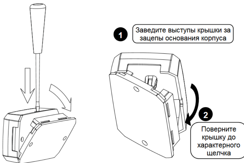
Рисунок 2.3. Снятие и установки крышки преобразователя
