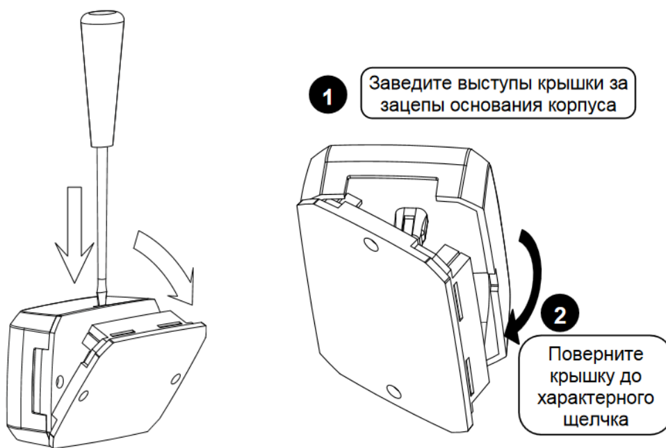
Рисунок 2.3. Снятие и установки крышки преобразователя
