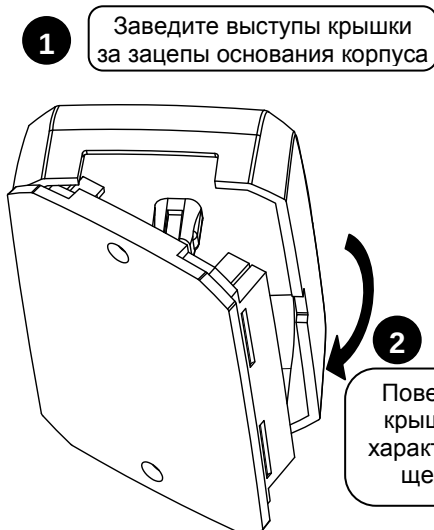
Рисунок 3. Установка крышки преобразователя
