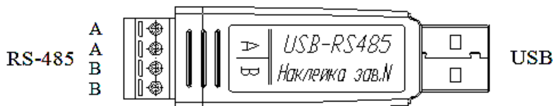
Рис.2.2 Схема подключения «USB-RS485»
