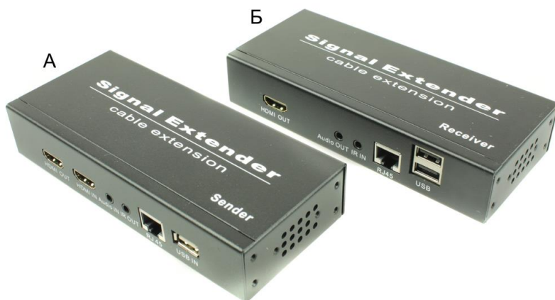
Рис.1 Комплект TLN-HiKMDA2+RLN-HiKMDA2, внешний вид (А – передатчик, Б – приемник)
