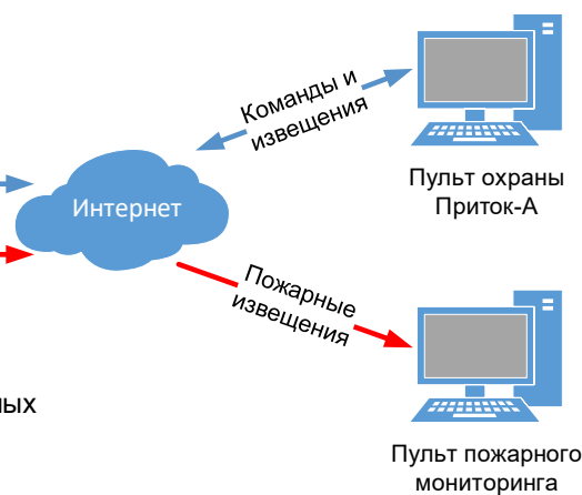
Рисунок 2.21.1 – Схема работы прибора с пультом пожарного мониторинга
