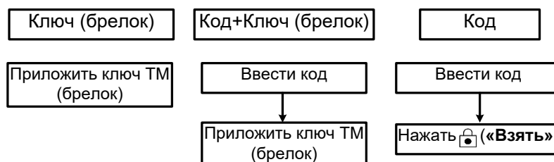
Рисунок 2.22 - Постановка под охрану без выбора ШС
