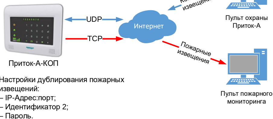
Рисунок 23 – Схема работы прибора с пультом пожарного мониторинга
