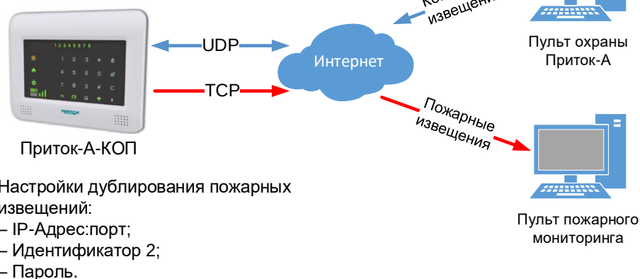
Рисунок 23 – Схема работы прибора с пультом пожарного мониторинга
