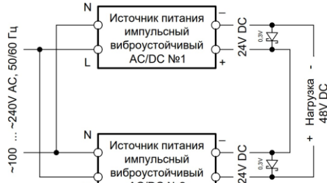
Последовательное подключение двух источников питания (с применением диодов Шоттки)
