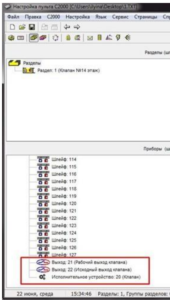
Рисунок 75 – Результат переопределения шлейфов прибора «С2000-КДЛ» в элементы адресного сигнально-пускового блока «С2000-СП4»
