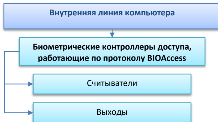
Рисунок 6-73 Схематическое отображение структуры внутренней линии компьютера с интерфейсом TCP/IP и протоколом BIOAccess
