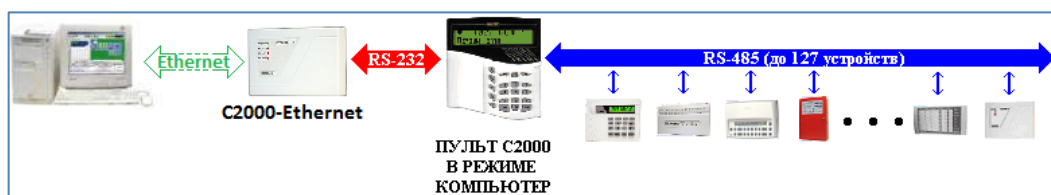
Рисунок 1-11 Схема подключения приборов через Ethernet по протоколу "Орион Про"
