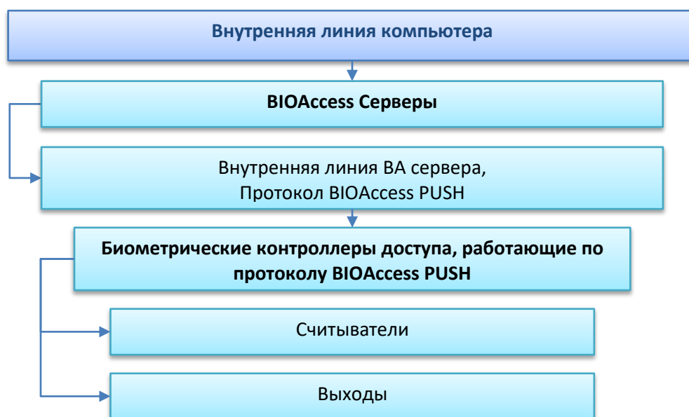
Рисунок 6-72 Схематическое отображение структуры внутренней линии компьютера с интерфейсом TCP/IP и протоколом BIOAccess BAServer
