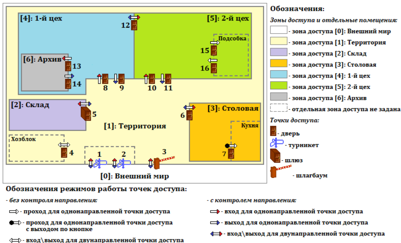
Рисунок 6-437 Пример расположения зон доступа и точек доступа на охраняемом объекте
