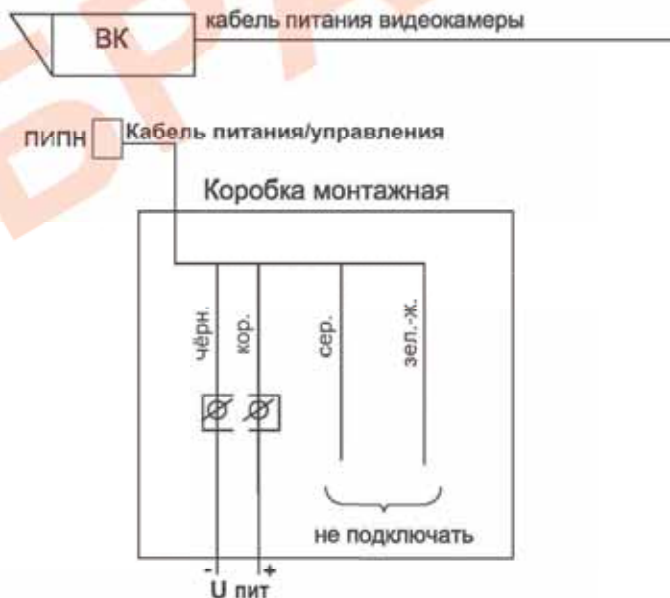
Рисунок 4 – Схемы подключения прожектора
