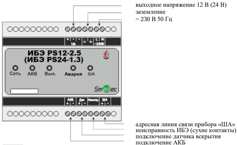
Рис. 3. Расположение контактов ИБЭ исполнений PS12-2.5 и PS24-1.3.
