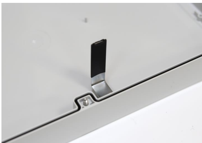
Рисунок 3.5.2 - Шторка датчика вскрытия на крышке коммутатора
