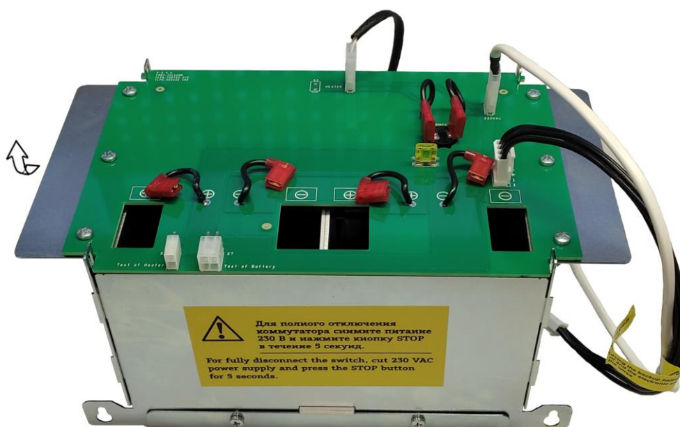
Рисунок 7.6 – Отсек с установленными АКБ.
