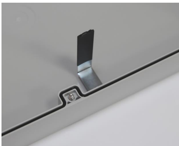
Рисунок 3.5.2 - Шторка датчика вскрытия на крышке блока
