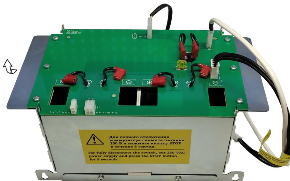
Рисунок 7.6 – Отсек с установленными АКБ.
