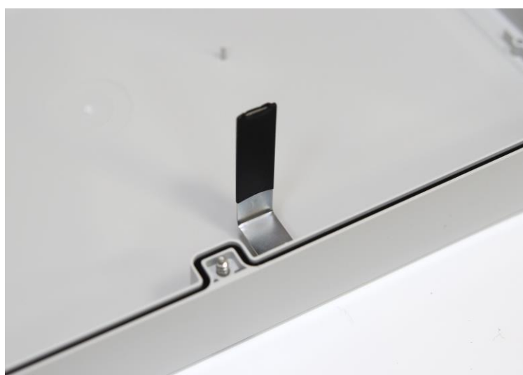
Рисунок 3.5.2 - Шторка датчика вскрытия на крышке коммутатора
