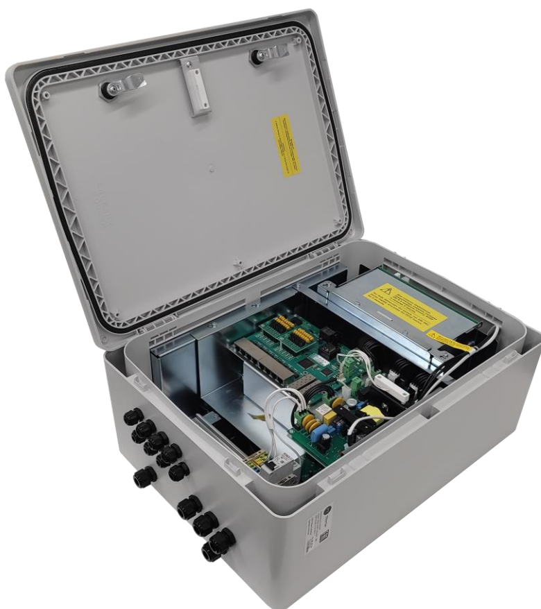
Рисунок 3.1.2 - PSW-2G8F+UPS-Box - вид внутри
