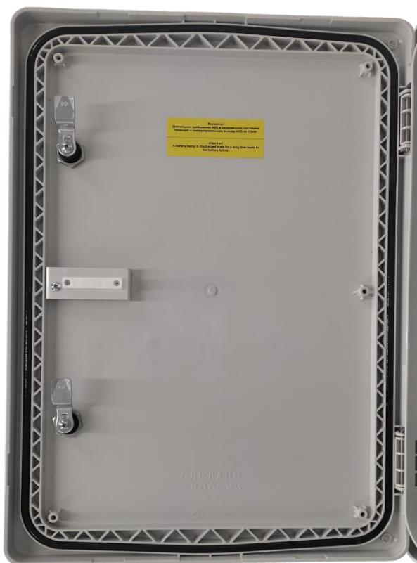
Рисунок 3.6.1 - Датчик вскрытия на крышке коммутатора
