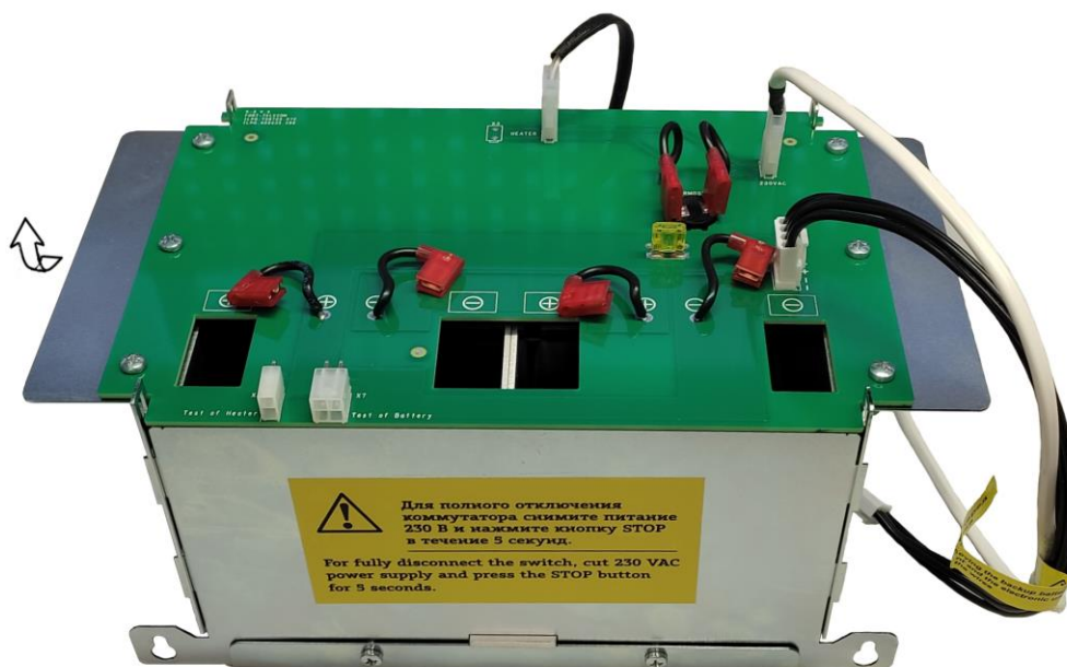
Рисунок 7.6 – Отсек с установленными АКБ.
