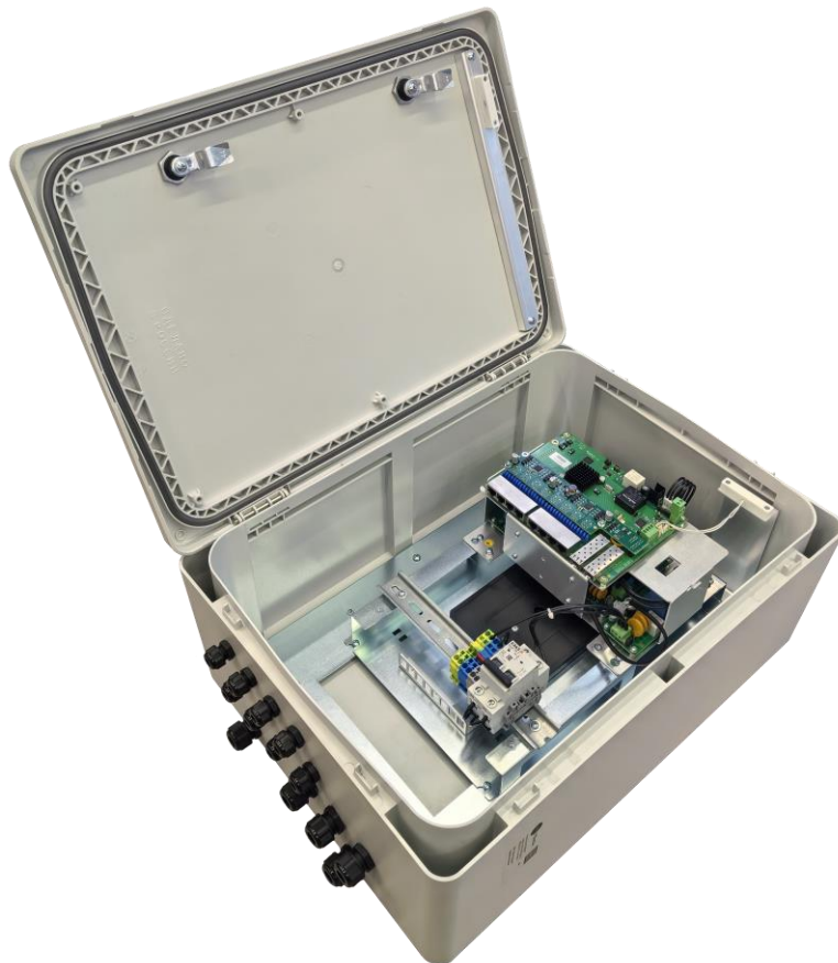
Рисунок 3.1.2 - PSW+ Box 8x2Pro - вид внутри
