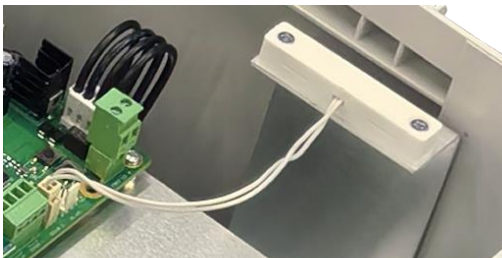
Рисунок 3.6.2 - Датчик вскрытия в корпусе коммутатора
