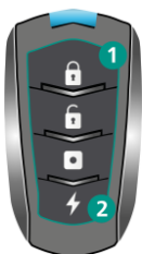
Рисунок 6.2 — Кнопки перевода брелока в режим связывания
